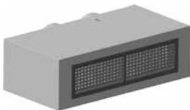
**Plenum de soufflage horizontal**, avec isolation acoustique, grille de soufflage avec diffusion d'air réglable horizontalement et verticalement – Bornier de raccordement électrique ( 230 V ) pour volet d'obturation de diam. 250 mm connecté ultérieurement
