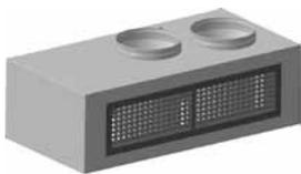
**Plenum de soufflage vertical avec volets tubulaires**, isolation acoustique, grille de soufflage avec diffusion d'air réglable horizontalement et verticalement – Raccordement des volets ( diam. 250 mm ) – Servomoteurs 230V – 5 Nm ( position ouverte / fermée )
