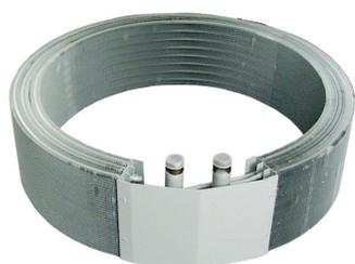
L'élément thermique de chauffage ou refroidissement du TopWing est une batterie Cu/Al avec trois rangées de tubes. Ceci présente l'avantage que des températures de soufflage d'env. 34 °C peuvent être atteintes, tant avec des installations de chauffage à basse température qu'avec des installations à condensation, avec une différence départ/retour de 50/40 °C et un débit maximal en mode air recyclé.)
