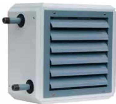
Les aérothermes de la série TLH-EC / TLH ont été développés spécialement pour un grand confort. Selon les modèles, les aérothermes sont conçus pour : chauffer, aérer ou filtrer. Chaque unité peut être utilisée avec équipement adéquat pour fonctionner avec l'air recyclé, de l'air mélangé ou de l'air neuf, elle peut être installée sur un mur ou au plafond. 4 modèles pour des débits jusqu'à 9400m<sup>3</sup>/h, et une puissance de chauffe jusqu'à 164 kW.
