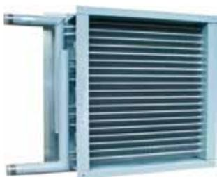
Des batteries de grandes dimensions sont utilisées comme éléments chauffants. Ceci présente l'avantage que des températures de soufflage d'environ 36°C peuvent être atteintes dans des conditions de différence de température départ/retour de 50/40°C, de débit maximal et de fonctionnement à l'air recyclé, et ce même avec un chauffage à basse température ou encore avec une installation à condensation.
